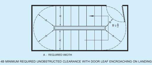
FIG. 4 DOOR LOCATION AT LANDING IN FIRE EXITS
